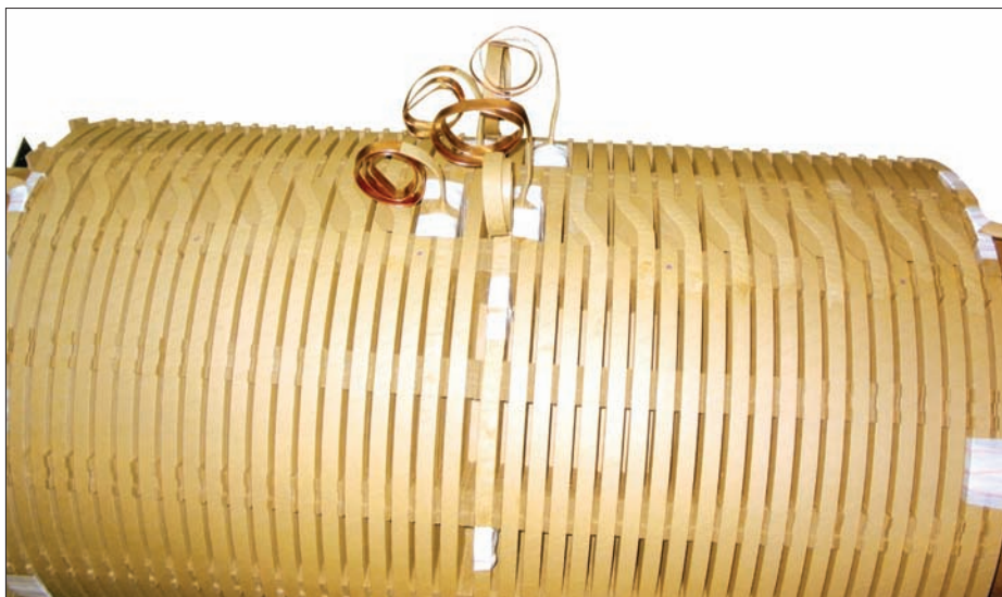
Înfășurare disc cu reglaj disc întrețesut, transformator 12 MVA, 45 kV, \pm 2,5\%
