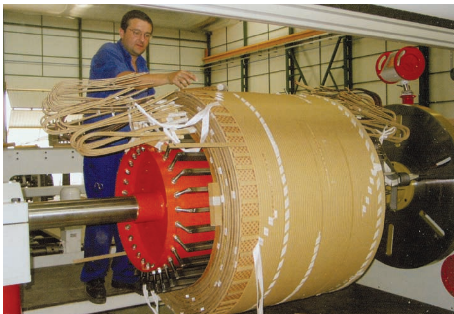
Înfășurare în strat transformator 40 MVA, 66 kV
